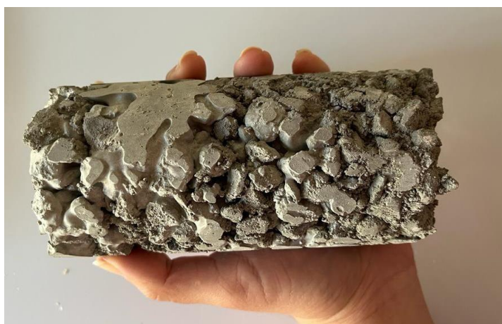
Figura 18 – Concreto de teste de moldagem manual.
