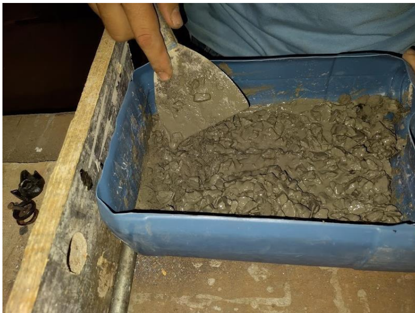
Figura 04 – Moldagem, teste manual, índice 0,3% aditivo.
