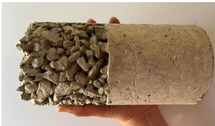
Figura 17 – Concreto em duas fases.
