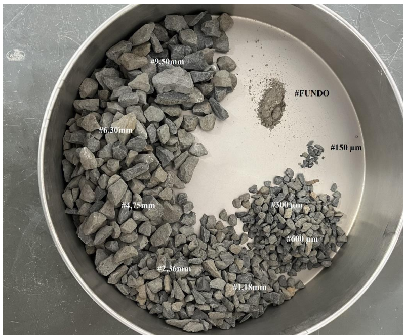
Figura 01 – Distribuição granulométrica do agregado graúdo.
