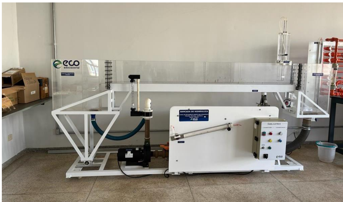
Figura 13 – Mesa hidráulica com tubo de Pitot.
