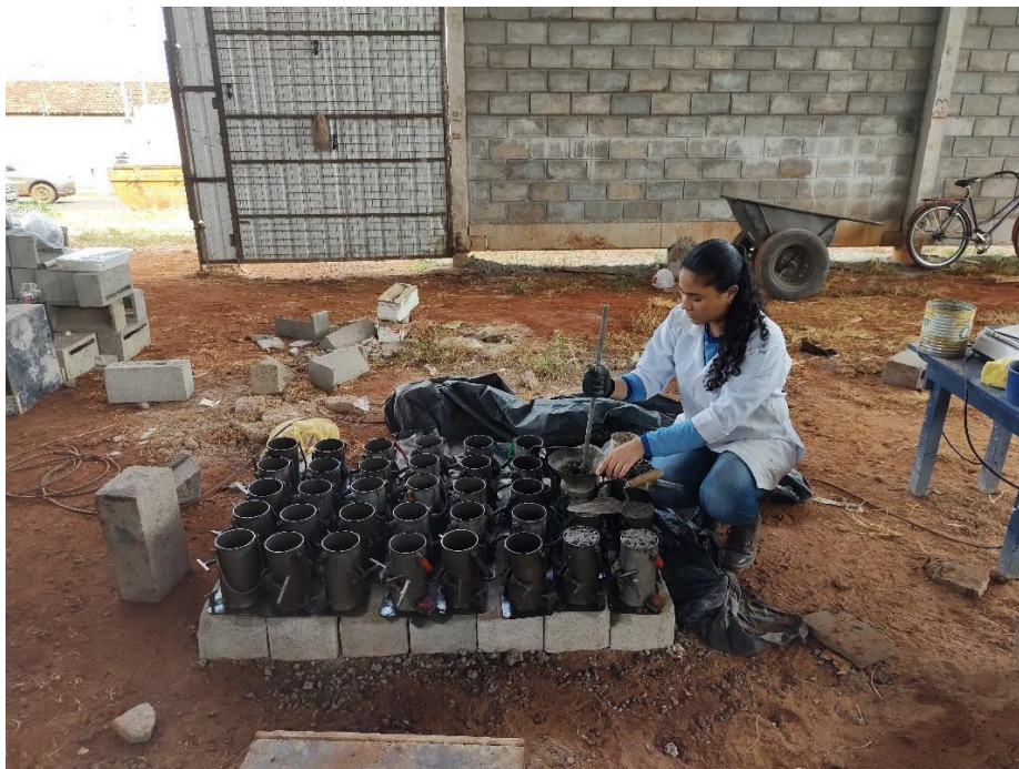
Figura 07 –Moldagem e compactação manual de corpos de prova cilíndricos.
