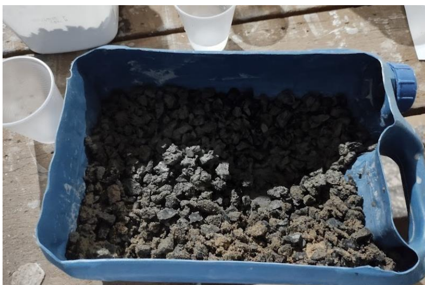
Figura 05 – Moldagem, teste manual, índice 0,1 % aditivo.
